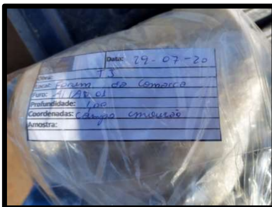
FOTO 6 – Coleta e etiquetagem de amostra indeformada - AI01
