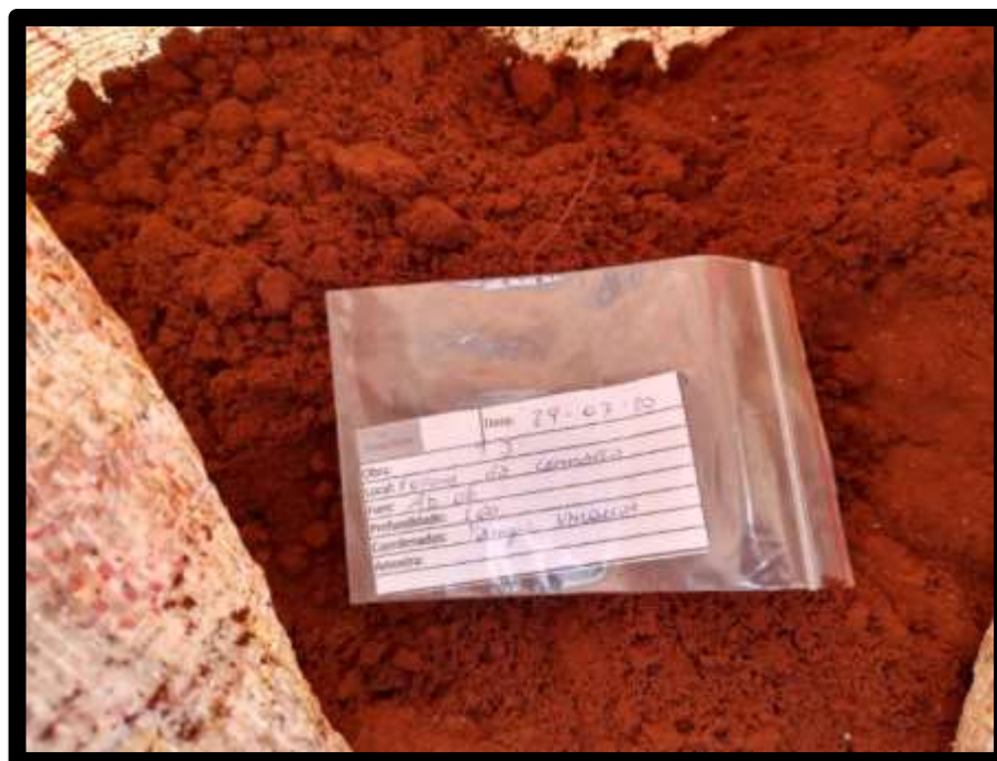
FOTO 8 – Coleta e etiquetagem de amostra deformada - AD06
