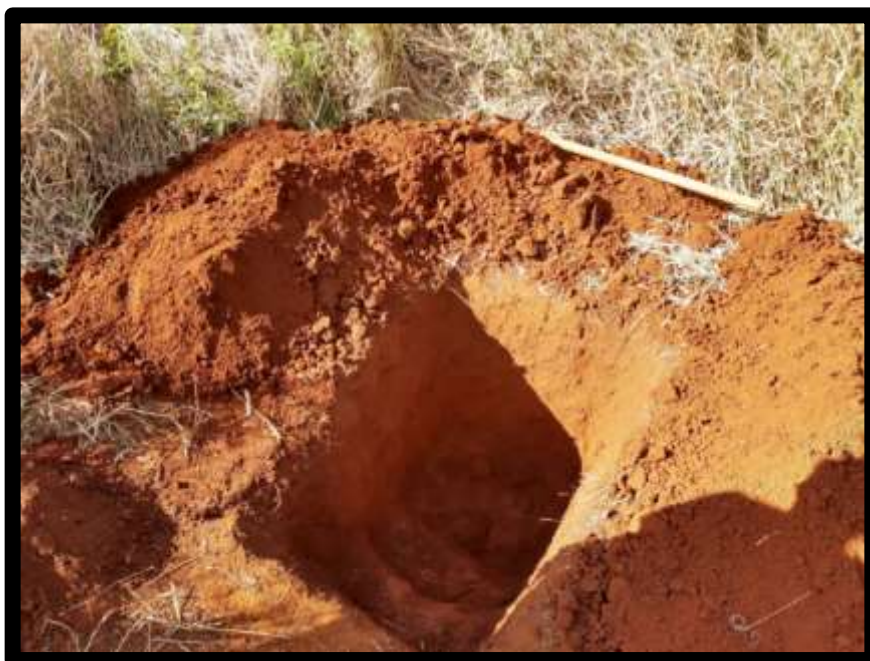
FOTO 3 - Abertura de furo para coleta de amostras
