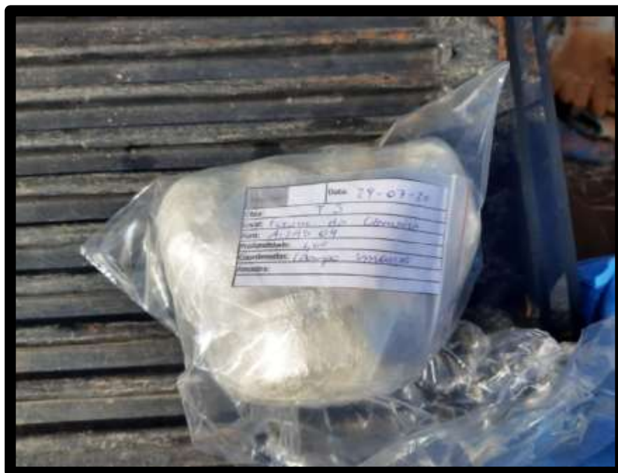
FOTO 7 – Coleta e etiquetagem de amostra indeformada - AI04
