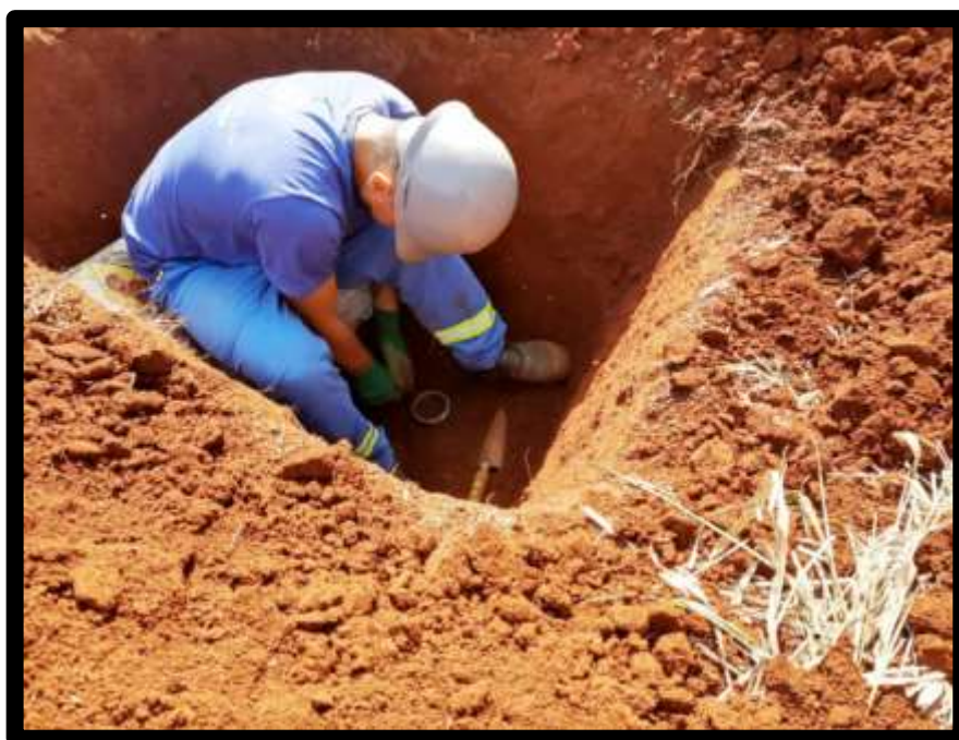
FOTO 4 – Cravação de anéis para coleta de amostra indeformada
